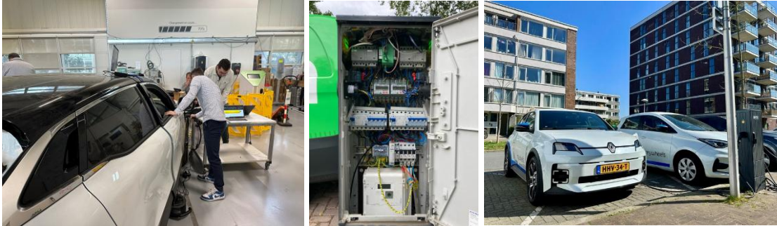
Figuur 7 In voorjaar 2025 zijn de eerste V2G Renault 5 deelauto's geplaatst door We Drive Solar en MyWheels in Utrecht. Links: testen van de nieuwe WDS-laadpaalcontroller bij het Renault Technocentre in Parijs; midden: vervanging van de controllers in de laadpalen door nieuwe versie die de nieuwe protocollen en cybeveiligheidseisen ondersteunt; rechts: eerste Renault 5 ingezet als MyWheels deelauto op V2G laadpaal.
